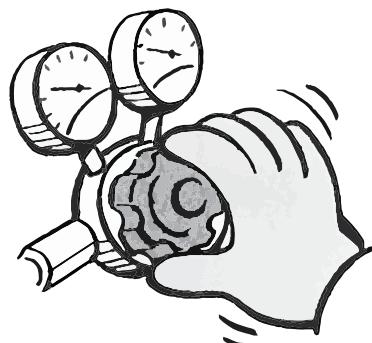
圧力調整ハンドルを操作して最高使用圧力まで上がるか確認する。
