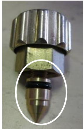
オ) 吹管本体の側面に空いている穴からのガス漏れを確認する。(注 1)
