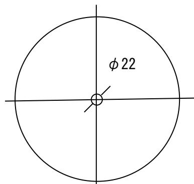
大型切断用金型（本図は丸型を示す）金型の重心の位置に  $\phi 22$  の穴加工を必要とします。
