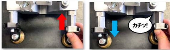
独自のリンク機構により、突出した側のガイドローラーを強く押し込むと左右の突き出しが切替わります。
